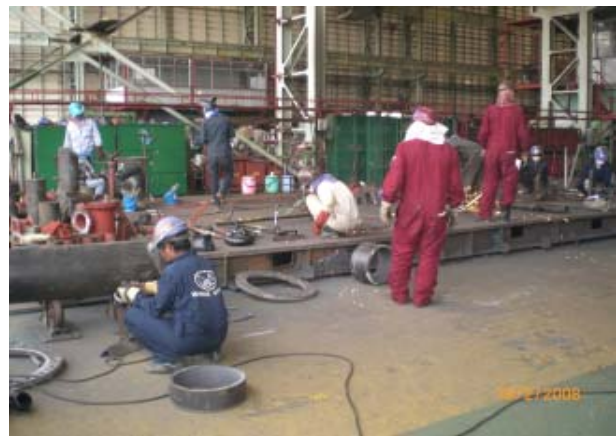
สภาพการทำงานในสถานประกอบกิจการผลิต โครงสร้างโลหะในจังหวัดระยอง ลูกจ้างกำลังทำงานเชื่อมชิ้นส่วนของ โครงสร้างโลหะ เพื่อนำไปประกอบและติดตั้งต่อไป
