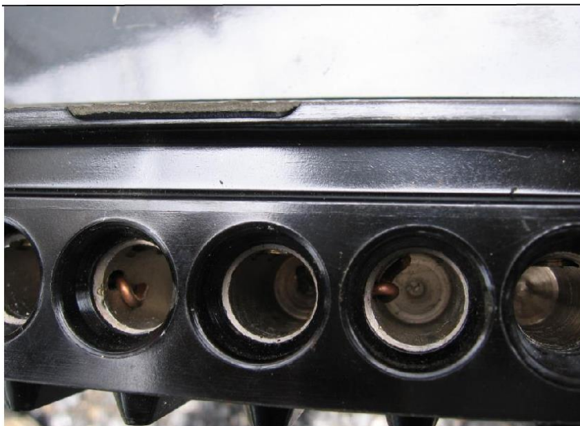
(รูปที่ ๑๐) เจาะรูและต่อลัดวงจร Current coil
