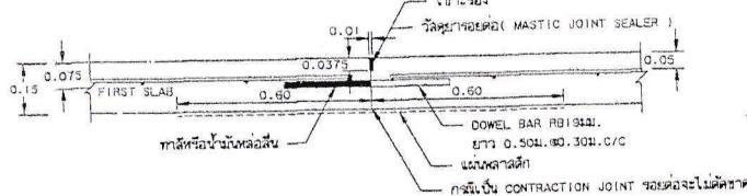
ຂໍ້ມູນຈອຍດອ CONSTRUCTION JOINT ແລະ CONTRACTION JOINT
