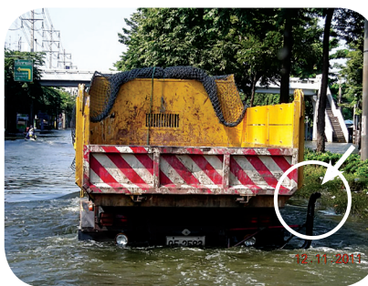
รูปที่ 11 การการต่อท่อไอเสียของรถเก็บขนขยะมูลฝอยให้สามารถใช้งานได้เมื่อเกิดอุทกภัย
