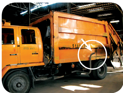
รูปที่ 11 การการต่อท่อไอเสียของรถเก็บขนขยะมูลฝอยให้สามารถใช้งานได้เมื่อเกิดอุทกภัย
