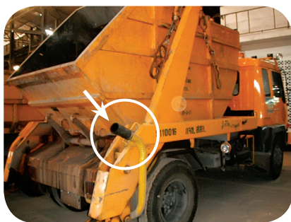
รูปที่ 11 การการต่อท่อไอเสียของรถเก็บขนขยะมูลฝอยให้สามารถใช้งานได้เมื่อเกิดอุทกภัย
