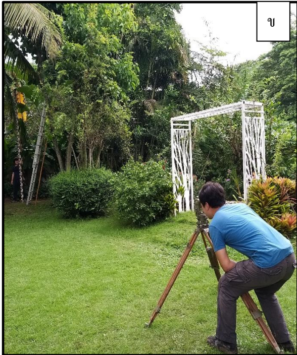
รูปที่ 7 (ก) อุปกรณ์สำรวจ เครื่องเจาะเก็บตัวอย่างดิน (Hand Auger) (ข) การวัดระดับด้วยกล้องวัดระดับ
