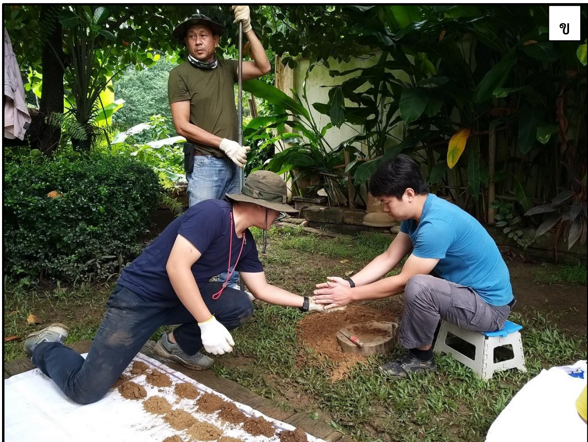
รูปที่ 8 (ก), (ข) การเจาะสำรวจตรวจสอบลักษณะชั้นดินและการเก็บตัวอย่างชั้นตะกอน
