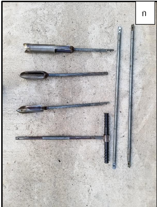
รูปที่ 7 (ก) อุปกรณ์สำรวจ เครื่องเจาะเก็บตัวอย่างดิน (Hand Auger) (ข) การวัดระดับด้วยกล้องวัดระดับ
