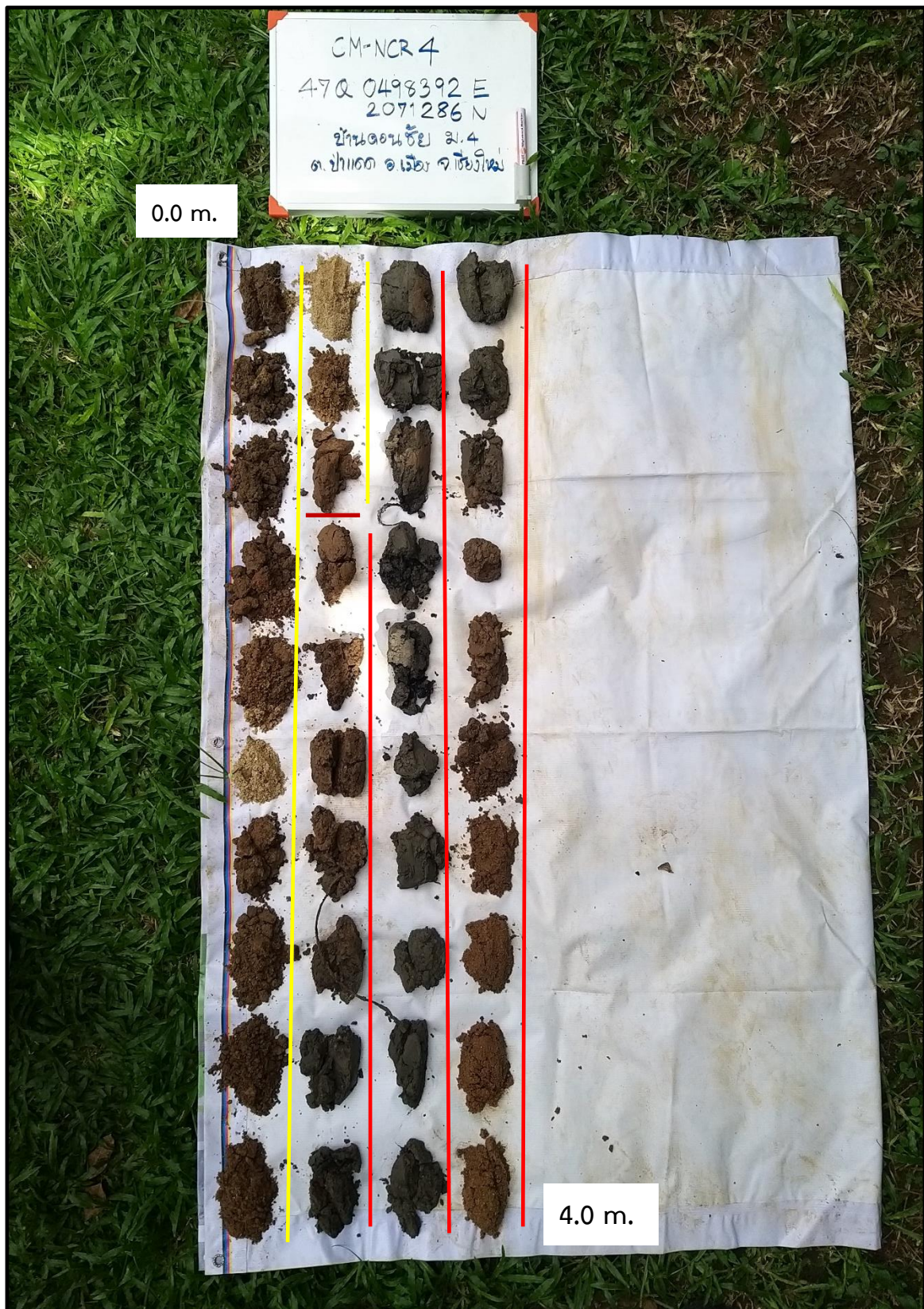
รูปที่ 13 ลักษณะตะกอนดินที่ได้จากการเจาะสำรวจหลุมเจาะที่ CM-NCR4
