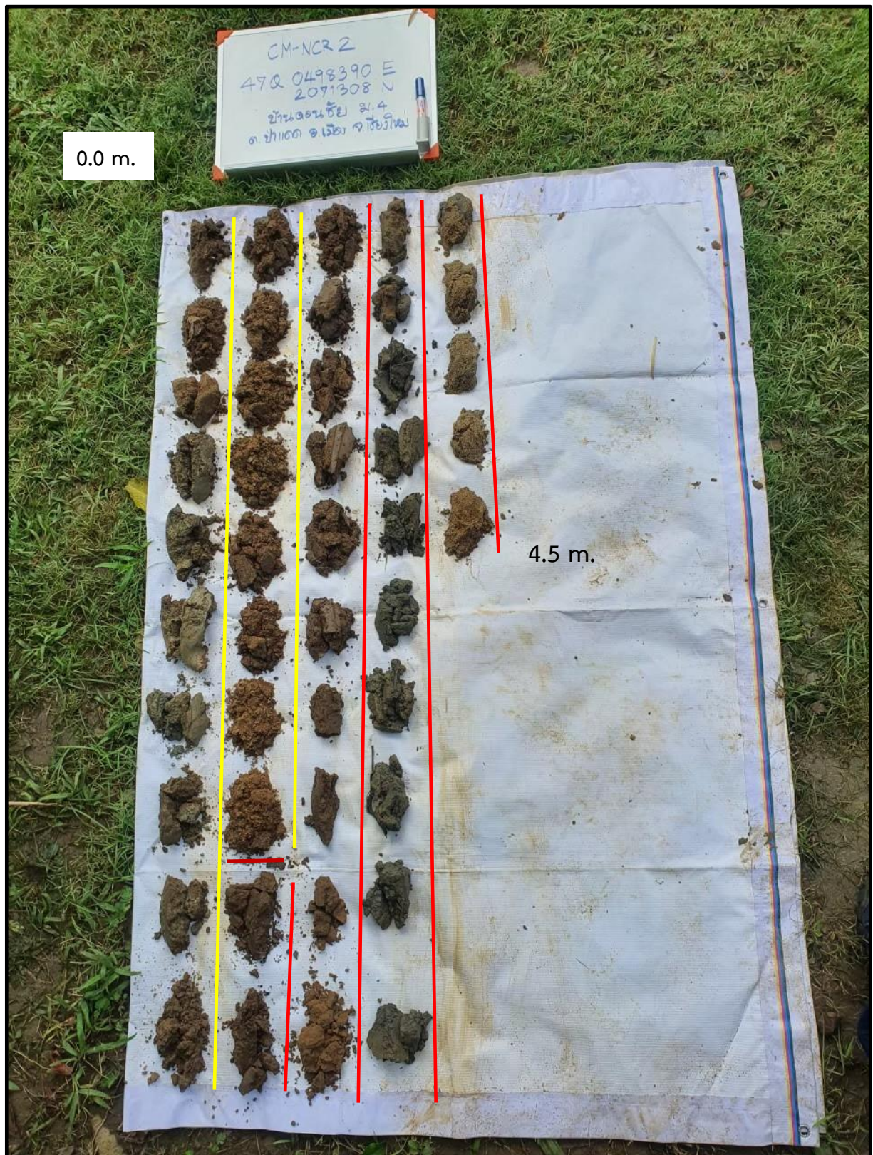
รูปที่ 11 ลักษณะตะกอนดินที่ได้จากการเจาะสำรวจหลุมเจาะที่ CM-NCR2
