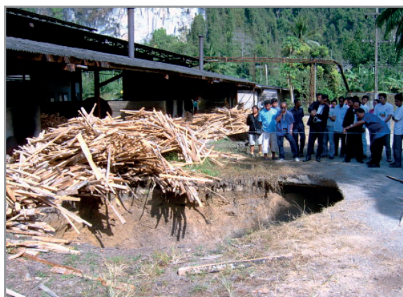
รูปที่ 4-5 ลักษณะหลุมยุบที่เกิดขึ้นจากแผ่นดินไหวขนาด 9.1 ริคเตอร์ เมื่อเดือนธันวาคม 2547 บริเวณโรงงานบริษัทกระป๋องน้ำมันพืช อำเภออ่าวลึก (ปัจจุบันได้ปิดหลุมไปแล้ว)
