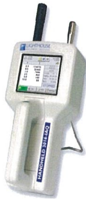
รูปที่ 3.2.3-2 รูปแสดงตัวอย่างเครื่องมือตรวจวัดฝุ่นละอองขนาดเล็กกว่า 2.5 ไมครอน (PM-2.5)
