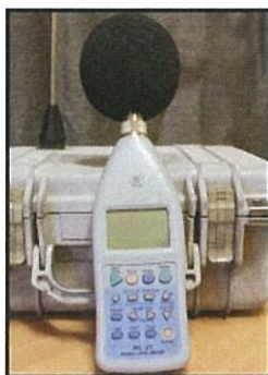
รูปที่ 3.2.3-4 รูปแสดงตัวอย่างเครื่องมือตรวจวัดระดับเสียงเฉลี่ย 5 นาที และระดับเสียงสูงสุด
