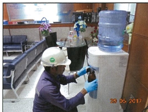
รูปที่ 8 รูปแสดงตัวอย่างวิธีการเก็บตัวอย่างน้ำดื่ม
