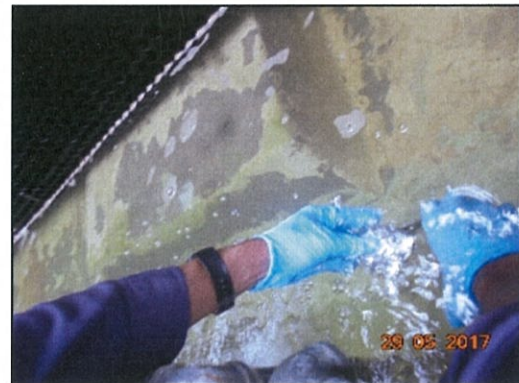
รูปที่ 6 รูปแสดงตัวอย่างวิธีการเก็บตัวอย่าง เชื้อแบคทีเรียกลุ่มลิสต์อีโอสลอส สปีชีส์ ในหอฝึ่งเย็น
