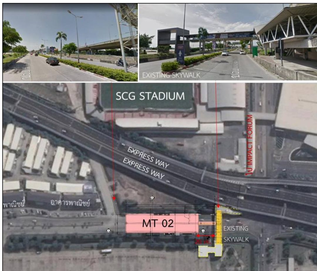
รูปที่ 2.3-29 ตำแหน่งสถานี MT-02 ออกแบบทางเชื่อมต่อไปยัง SKYWALK เดิมของอิมแพ็คฟอรั่ม
