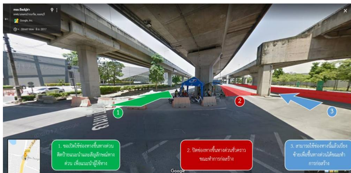
รูปที่ 2.11-2 แสดงการจัดช่องจราจรทางขึ้นทางพิเศษอุดรรัถยา ที่ปิดเบี่ยงและช่องจราจรที่จะเปิดใช้งานแทนช่องทางขึ้นเดิม
