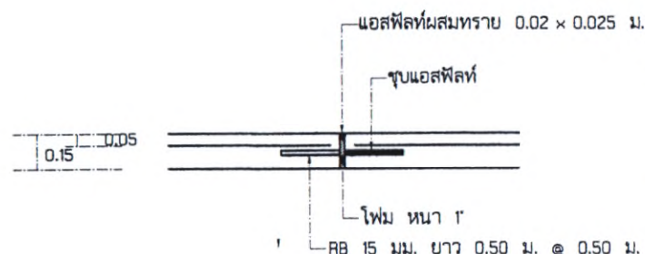
ขยาย EXPANTION JOINT
