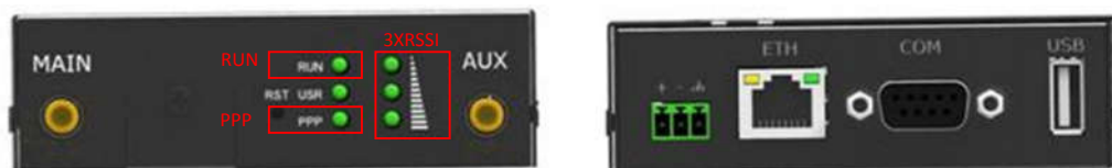
รูปที่ 4.4 LED แสดงสถานะการทำงานของอุปกรณ์ GPRS Modem
