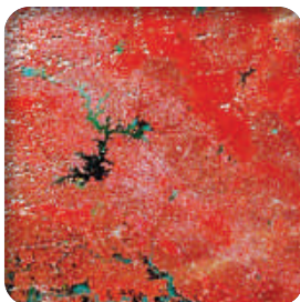
ภาพ ข้อมูลแบนด์ที่ใช้ในการผสมสีภาพ และการผสมสีภาพ (Color Composite) R-G-B : 4-5-3 ในพื้นที่ จ.กาฬสินธุ์ เดือนตุลาคม 2565
