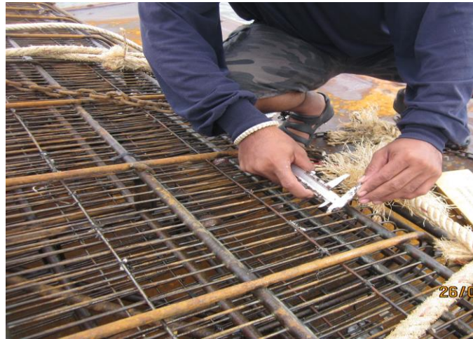
ภาพที่ ๗ การวัดขนาดซี่คราดจากด้านในของซี่คราดหนึ่งไปยังด้านในของซี่คราดถัดไปที่อยู่ใกล้สุด
