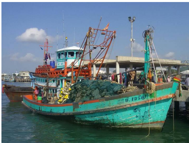
ภาพที่ ๔ ลักษณะของเรือประมงที่ใช้เครื่องมืออวนล้อมจับปลากะตัก และการล้อมฝูงปลา
