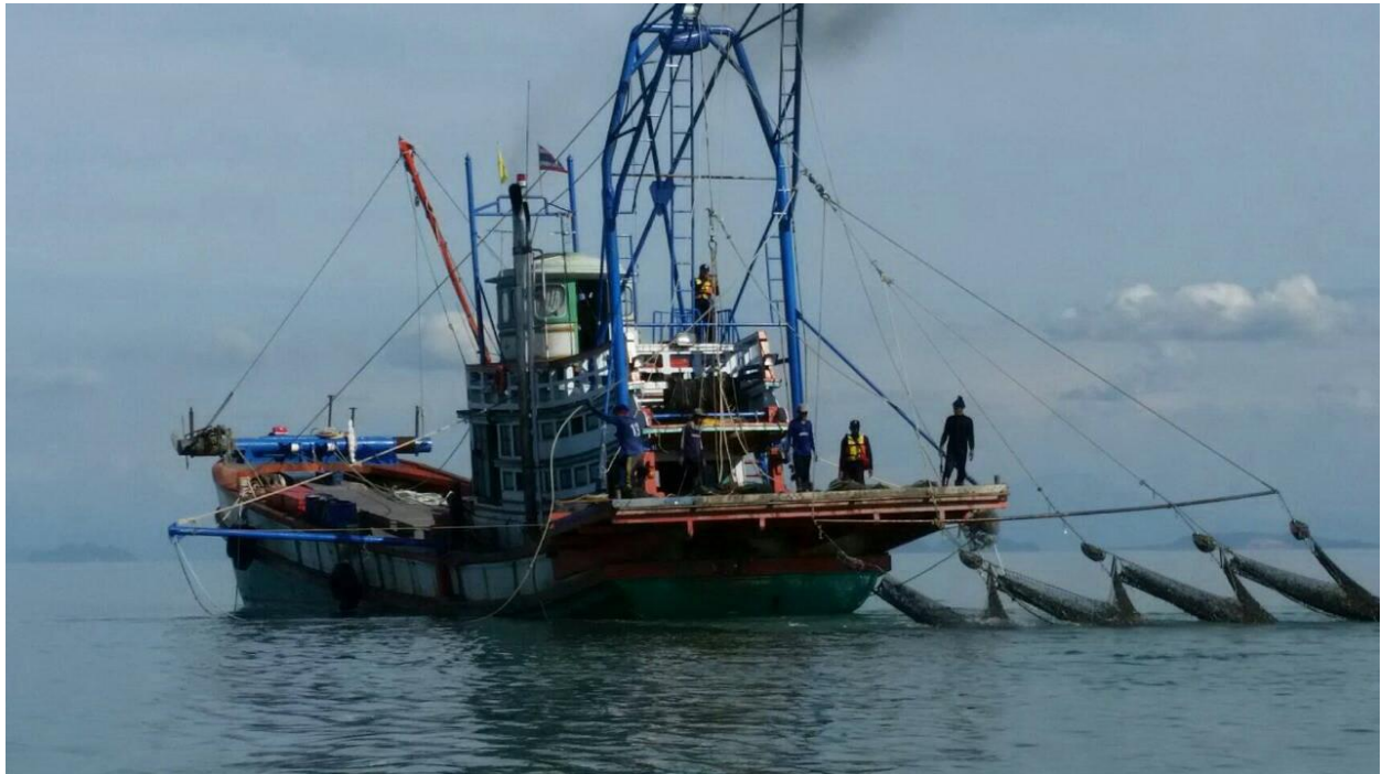
ภาพที่ ๓ ลักษณะของเรือประมงที่ใช้อวนลากคานถ่าง ขณะทำการประมง
