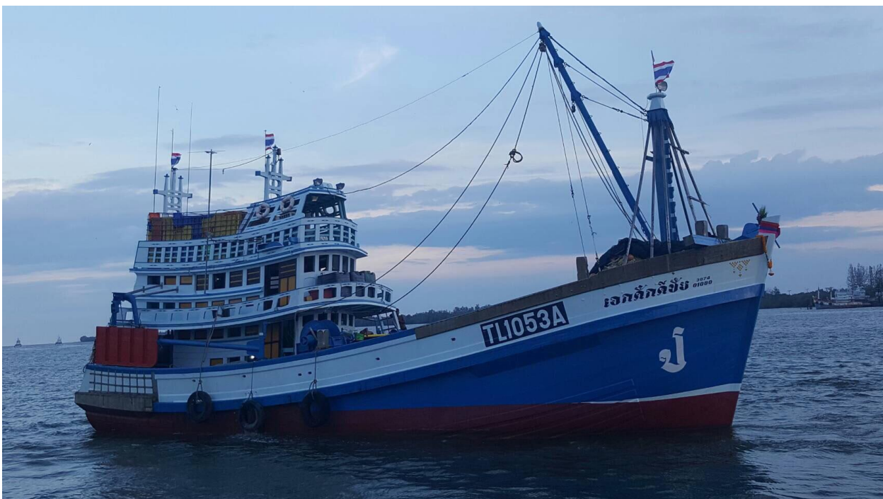
ภาพที่ ๒ ลักษณะของเรือประมงเครื่องมืออวนลากแผ่นตะเฆ่
