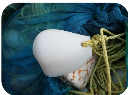
ภาพที่ ๗๕ ลักษณะของเครื่องมือลอบหมึกสายที่ทำจากเปลือกหอยสังข์จุกพราหมณ์ (ของจริง)
