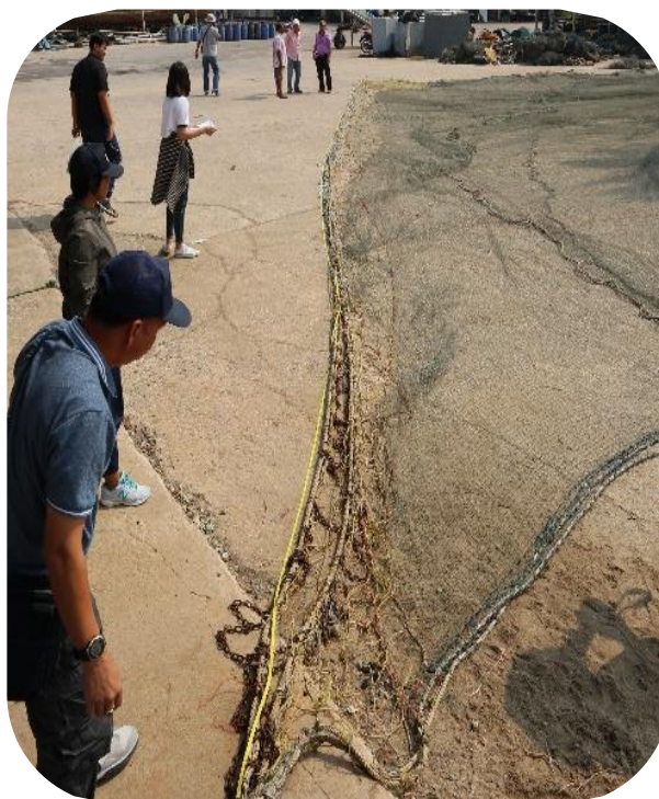
ภาพที่ ๑๓ วิธีวัดความยาวคร่าวล่างของอวนลากแผ่นตะเฆ่ (กรณีอวนวางบนพื้น)
