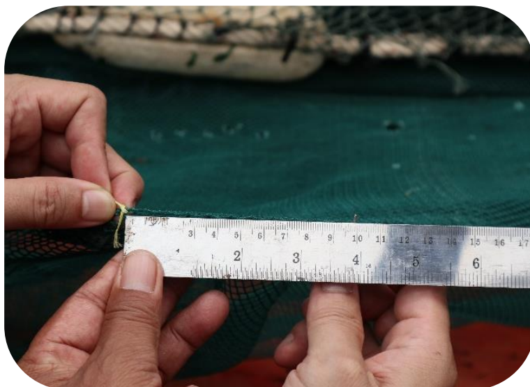
ภาพที่ ๕๗ การวัดขนาดตาอวนของเครื่องมืออวนครอบปลาเกตุ
