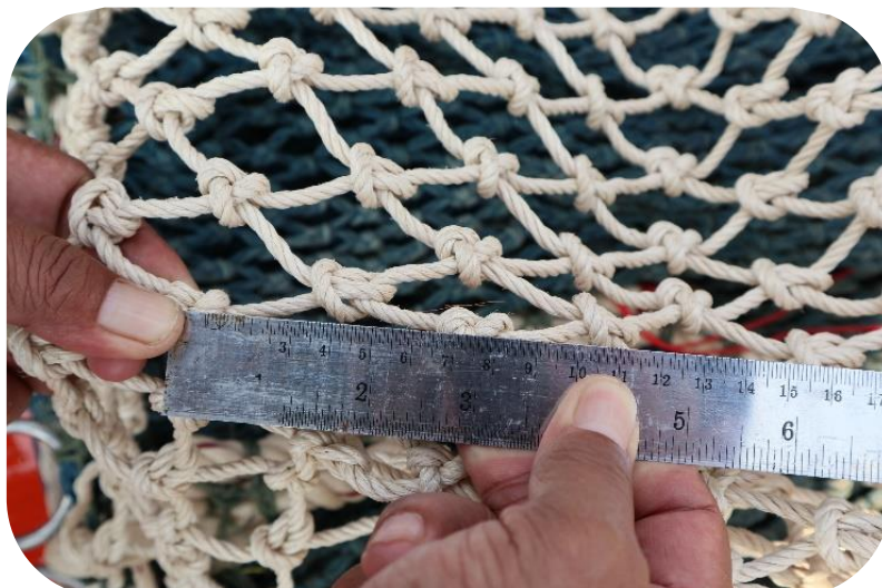
ภาพที่ ๓๕ ลักษณะตาอวนกันถุงที่จะต้องทำการวัด
