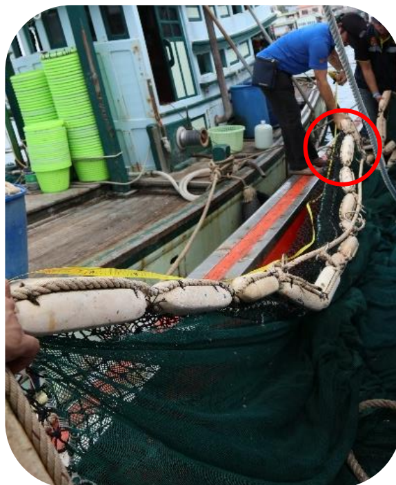
ภาพที่ ๕๖ การวัดความยาวคร่าวบนจากหูวนด้านหนึ่งไปยังหูวนอีกด้านหนึ่ง
