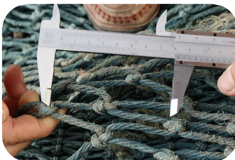
ภาพที่ ๑๘ การวัดขนาดตาอวนรองกันถุง ๑ ตา
