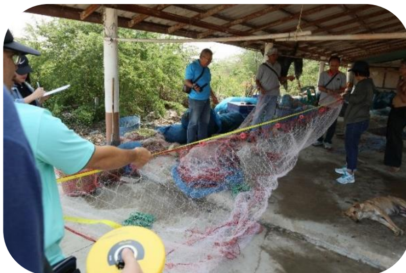
ภาพที่ ๖๑ การวัดความยาวคร่าวบนของอวนติดตา
