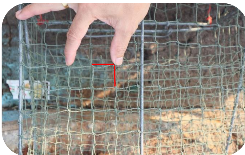
ภาพที่ ๗๔ การวัดขนาดตาอวนท้องลอบปู
