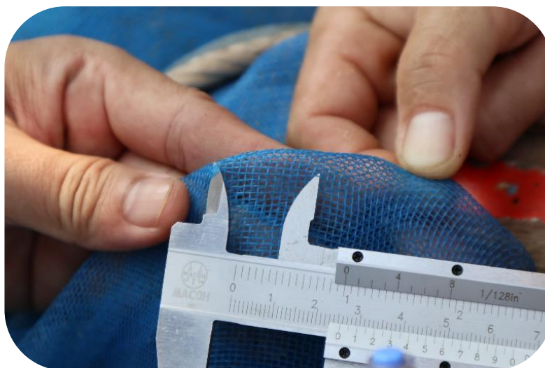
ภาพที่ ๖๕ การวัดจากด้านหนึ่งไปจนถึงด้านตรงข้ามเป็นระยะ ๑ นิ้ว
