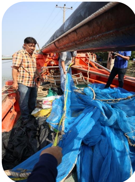
ภาพที่ ๖๗ การวัดความยาวคร่าวล่างของอวนรุนเคย
