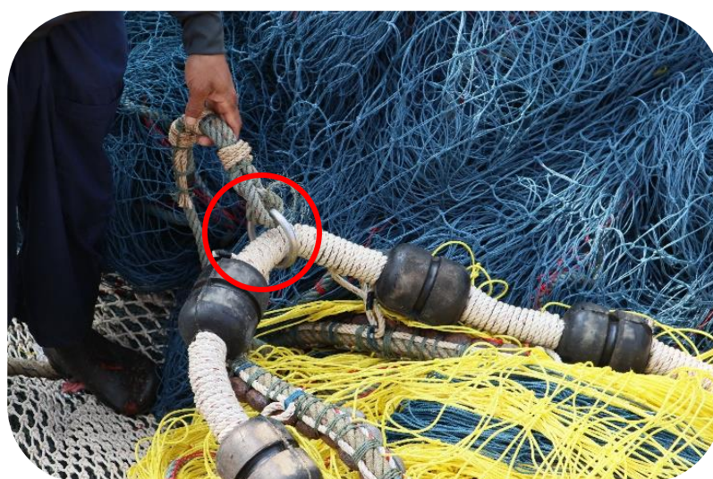
ภาพที่ ๒๙ จุดเริ่มต้นการวัดคร่าวล่าง (บริเวณหูอวน จุดที่เนื้ออวนเย็บติดกับเชือกคร่าวล่าง)
