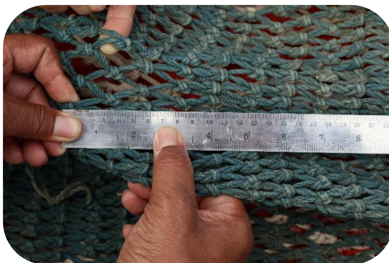
ภาพที่ ๓๔ ลักษณะการวัดตาอวนก้นถุง
