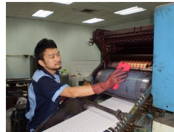
ขณะช่างพิมพ์ใช้ทำความสะอาด โม่แม่พิมพ์ โม่ผ้ายาง โม่แรงกด
