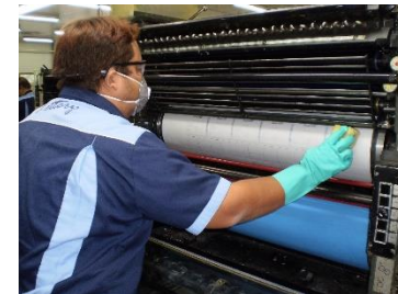
ขณะช่างพิมพ์ใช้ทำความสะอาด โม่แม่พิมพ์ โม่ผ้ายาง โม่แรงกด
