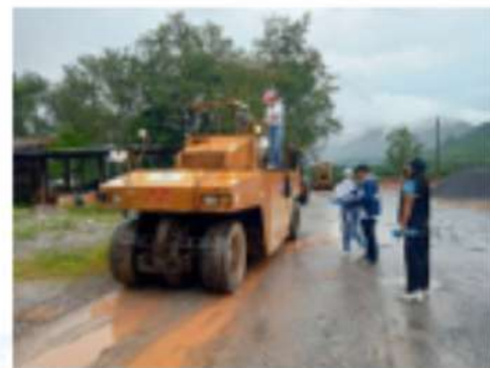
ลำดับที่ ๑๓ รถบดอัดสั่นสะเทือนชนิดขับเคลื่อนด้วยตัวเอง (Self-Propelled Vibrating Roller) ขนาด ๑๑ ตัน
