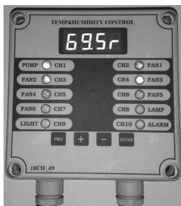
รูปที่ 8.1-4 อุปกรณ์ควบคุมอุณหภูมิภายในโรงเรือน
