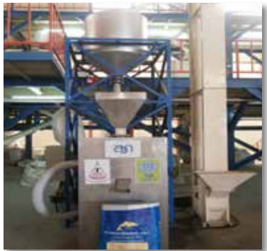
เครื่องให้ความร้อนแบบไดอิเล็กตริก สำหรับหม่อมอดข้าว
