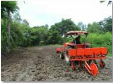
เครื่องปลูกสับปรดแบบพ่วงท้าย รถแทรกเตอร์ขนาดเล็ก
