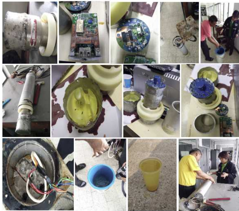
รูปที่ 4 หัววัดรังสีโซเดียมไอโอไดด์ (NaI) ชำรุดเสียหายจากน้ำทะเล
