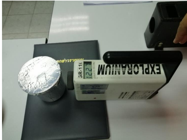
เครื่อง Survey Meter วัดค่าไม่ถูกต้อง ค่าสูงเกินจริง
