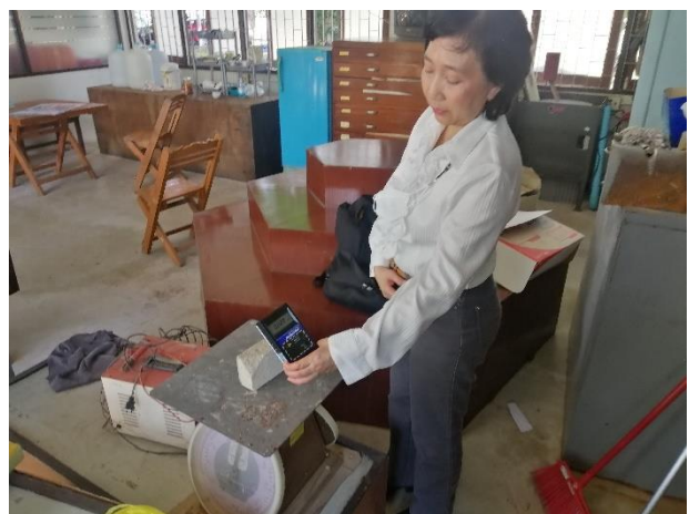
พบรังสีใน อิฐทนไฟ วัดรังสีได้ ๑.๑๖๔ ไมโครซีเวิร์ตต่อชั่วโมง
