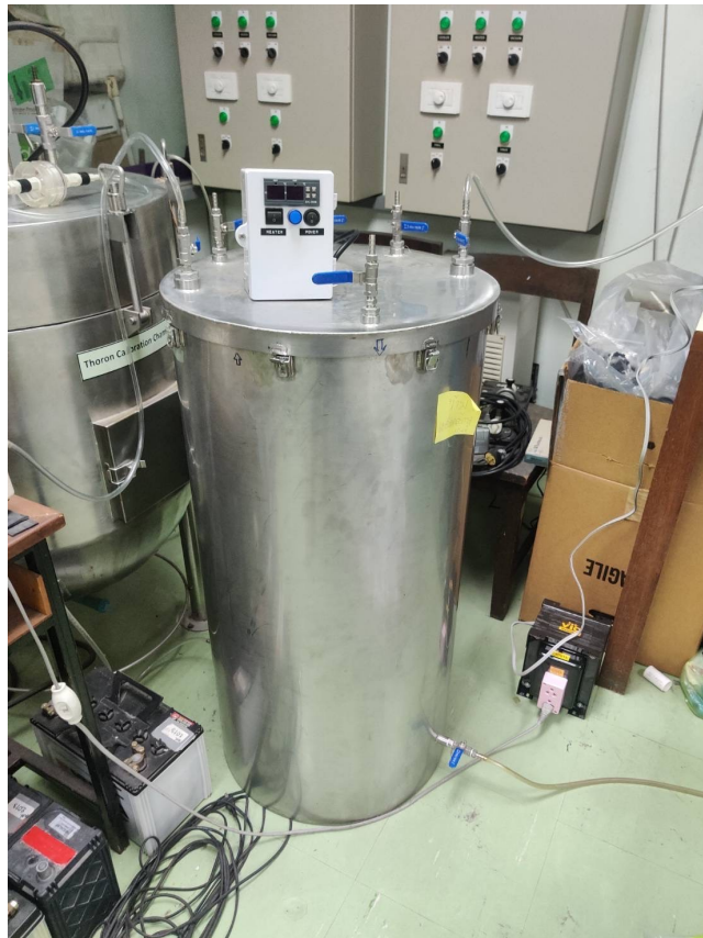
รูปที่ ๒ Radon chamber ของจุฬาลงกรณ์มหาวิทยาลัย
