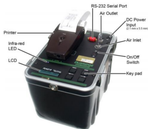
รูปที่ ๓ เครื่อง RAD๗ ชนิดหัววัดแบบกึ่งตัวนำ
