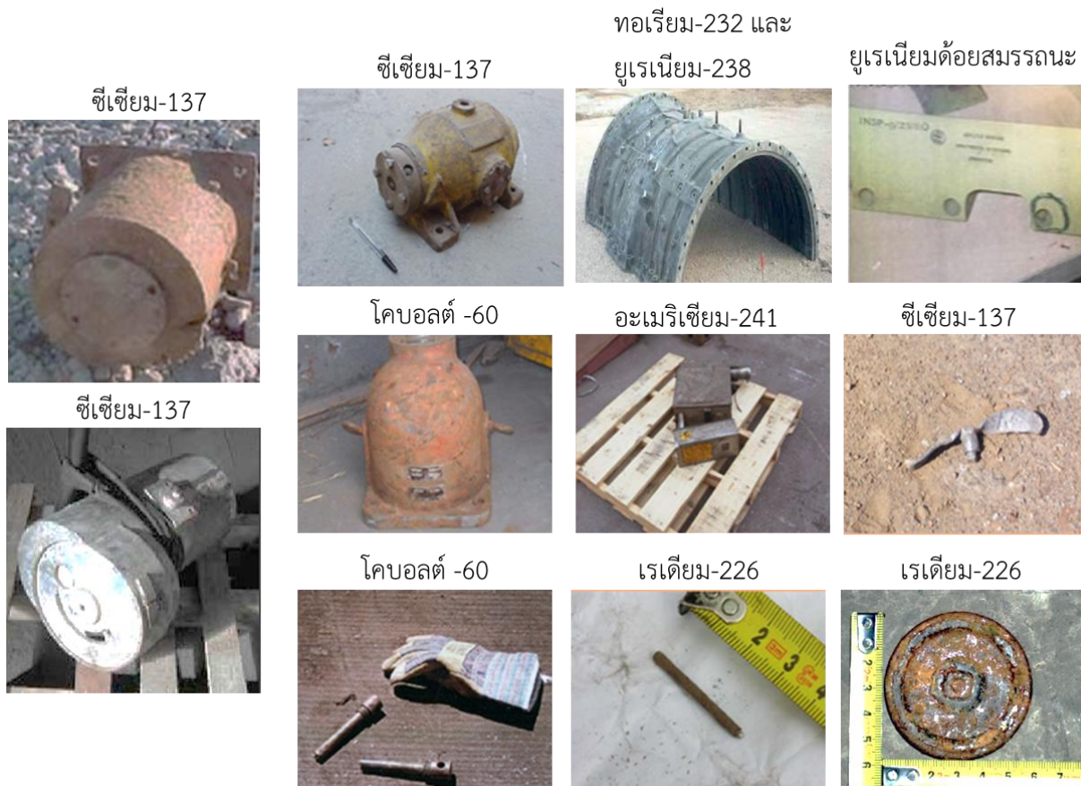
รูปที่ ๓-๑ แสดงลักษณะวัสดุหรือสิ่งของที่คาดการณ์ได้ว่าจะเป็นต้นกำเนิดรังสีที่อยู่นอกเหนือการกำกับดูแล (ที่มา https://gnssn.iaea.org/CSN/Scrap/Database%20of%20Sources/Home.aspx )
