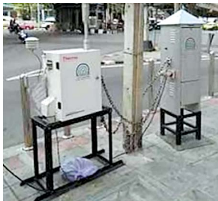
รูปที่ 8-1 ภาพเครื่องเก็บตัวอย่างฝุ่นขนาดเล็กบริเวณริมเส้นทางจราจร
