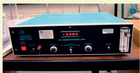
ภาพแสดงลักษณะภายนอกและภายในของเครื่องวัดก๊าซคาร์บอนมอนอกไซด์โดยใช้เครื่องตรวจวัดระบบนินดิสเพอร์ซีฟอินฟราเรดดีเทคชั่น
