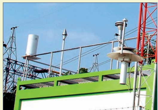
ภาพแสดงเครื่องมือตรวจวัดอุตุนิยมวิทยาซึ่งติดตั้งที่สถานีตรวจวัดคุณภาพอากาศ ภาพซ้ายคือ อุปกรณ์วัดความเร็ว และทิศทางลม ภาพขวาคือ อุปกรณ์วัดปริมาณน้ำฝน(ซ้าย) ท่อชักตัวอย่างอากาศ อุปกรณ์วัดความชื้น อุณหภูมิ และความดันบรรยากาศ (ขวา)
