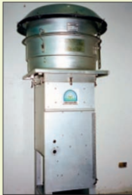
ภาพแสดงเครื่องเก็บตัวอย่างฝุ่นละอองแบบ High Volume Air Sampler สำหรับเก็บตัวอย่างฝุ่นละอองชนิด TSP (ซ้าย) และ PM10 (กลาง) แบบกึ่งอัตโนมัติ และการติดตั้งบริเวณริมถนน (ขวา)
