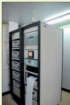
ภาพแสดงเครื่องมือตรวจวัดคุณภาพอากาศในบรรยากาศที่ติดตั้งภายในสถานี ในภาพประกอบด้วยเครื่องตรวจวัดฝุ่นละอองขนาดเล็กกว่า 10 ไมครอนชนิดรังสีเบต้า และเครื่องวัดปริมาณก๊าซในบรรยากาศ
