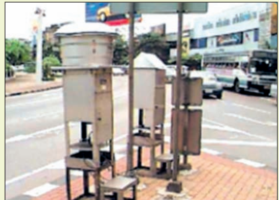
ภาพแสดงเครื่องเก็บตัวอย่างฝุ่นละอองแบบ High Volume Air Sampler สำหรับเก็บตัวอย่างฝุ่นละอองชนิด TSP (ซ้าย) และ PM10 (กลาง) แบบกึ่งอัตโนมัติ และการติดตั้งบริเวณริมถนน (ขวา)
