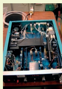
ภาพแสดงลักษณะภายนอกและภายในของเครื่องวัดก๊าซคาร์บอนมอนอกไซด์โดยใช้เครื่องตรวจวัดระบบนินดิสเพอร์ซีฟอินฟราเรดดีเทคชั่น
