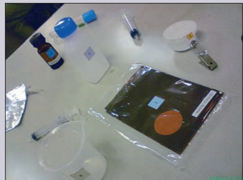
ภาพแสดงอุปกรณ์เก็บตัวอย่างอากาศแบบ Passive sampling ที่พัฒนาขึ้นโดยนักวิจัยไทยจากมหาวิทยาลัยศิลปากร
