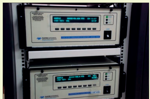
ภาพแสดงเครื่องมือตรวจวัดคุณภาพอากาศในบรรยากาศที่ติดตั้งภายในสถานี ในภาพประกอบด้วยเครื่องตรวจวัดฝุ่นละอองขนาดเล็กกว่า 10 ไมครอนชนิดรังสีเบต้า และเครื่องวัดปริมาณก๊าซในบรรยากาศ
