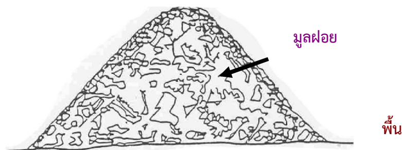
รูปที่ .. ลักษณะการกองมูลฝอยให้เป็นรูปกรวย ก่อนที่จะแบ่งมูลฝอยออกเป็น 4 ส่วน
