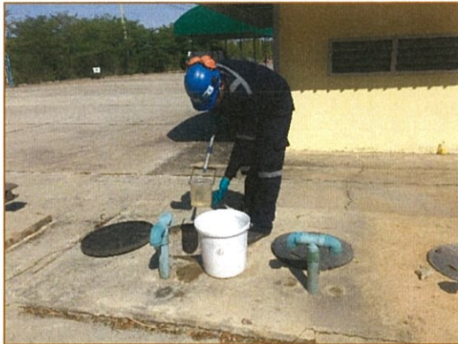
ภาพถ่ายที่ 5.1-1 แสดงการเก็บตัวอย่างคุณภาพน้ำทิ้ง ณ สถานที่กำจัดขยะมูลฝอยติดเชื้อ องค์การบริหารส่วนจังหวัดนนทบุรี วันที่ 4 พฤษภาคม 2562
