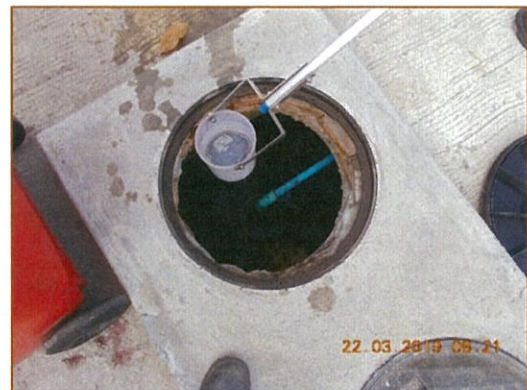
ภาพถ่ายที่ 6.3-1 แสดงการเก็บตัวอย่างคุณภาพน้ำทิ้ง ณ ศูนย์เทคโนโลยีบริหารจัดการระบบกำจัดมูลฝอยติดเชื้อภาคกลาง องค์การบริหารส่วนจังหวัดนนทบุรี วันที่ 22 มีนาคม 2562
