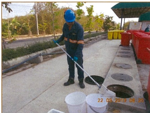
ภาพถ่ายที่ 6.3-1 แสดงการเก็บตัวอย่างคุณภาพน้ำทิ้ง ณ ศูนย์เทคโนโลยีบริหารจัดการระบบกำจัดมูลฝอยติดเชื้อภาคกลาง องค์การบริหารส่วนจังหวัดนนทบุรี วันที่ 22 มีนาคม 2562
