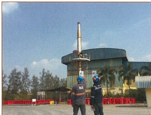
ภาพถ่ายที่ 6.1-1 จุดชักตัวอย่างอากาศและขั้นตอนการตรวจวัดคุณภาพอากาศที่ระบายออกจากปล่อง เตาเผามูลฝอย ณ ศูนย์บริหารจัดการมูลฝอยติดเชื้อ องค์การบริหารส่วนจังหวัดนนทบุรี ระยะที่ 1 เมื่อวันที่ 8 กุมภาพันธ์ 2562
