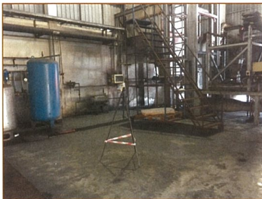
ภาพถ่ายที่ 6.2-1 แสดงการตรวจวัดระดับเสียงบริเวณหน้าเตาเผามูลฝอยติดเชื้อ ณ ศูนย์บริหารจัดการมูลฝอยติดเชื้อ องค์การบริหารส่วนจังหวัดนนทบุรี ระยะที่ 1 วันที่ 8 กุมภาพันธ์ 2562
