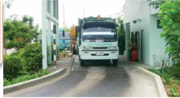
ขนน้ำหนักขยะมูลฝอยก่อนเข้าทิ้ง
