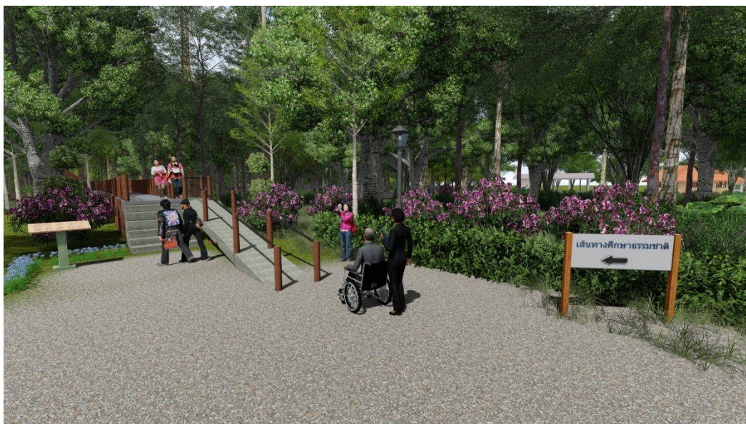
ภาพที่ 67 เส้นทางสัญจรที่มีความลาดชันต่างระดับและเสี่ยงต่อการเกิดอุบัติเหตุติดตั้งให้มีอุปกรณ์และสิ่งอำนวยความสะดวกช่วยการสัญจรและจับยึด
