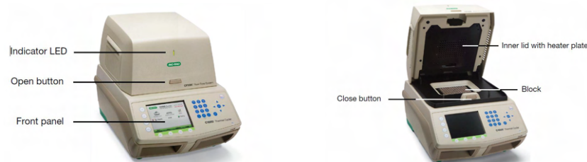
รูปที่ 19 ส่วนประกอบของเครื่องเพิ่มปริมาณสารพันธุกรรมในสภาพจริง (Real-Time PCR) ยี่ห้อ Biorad รุ่น CFX96
