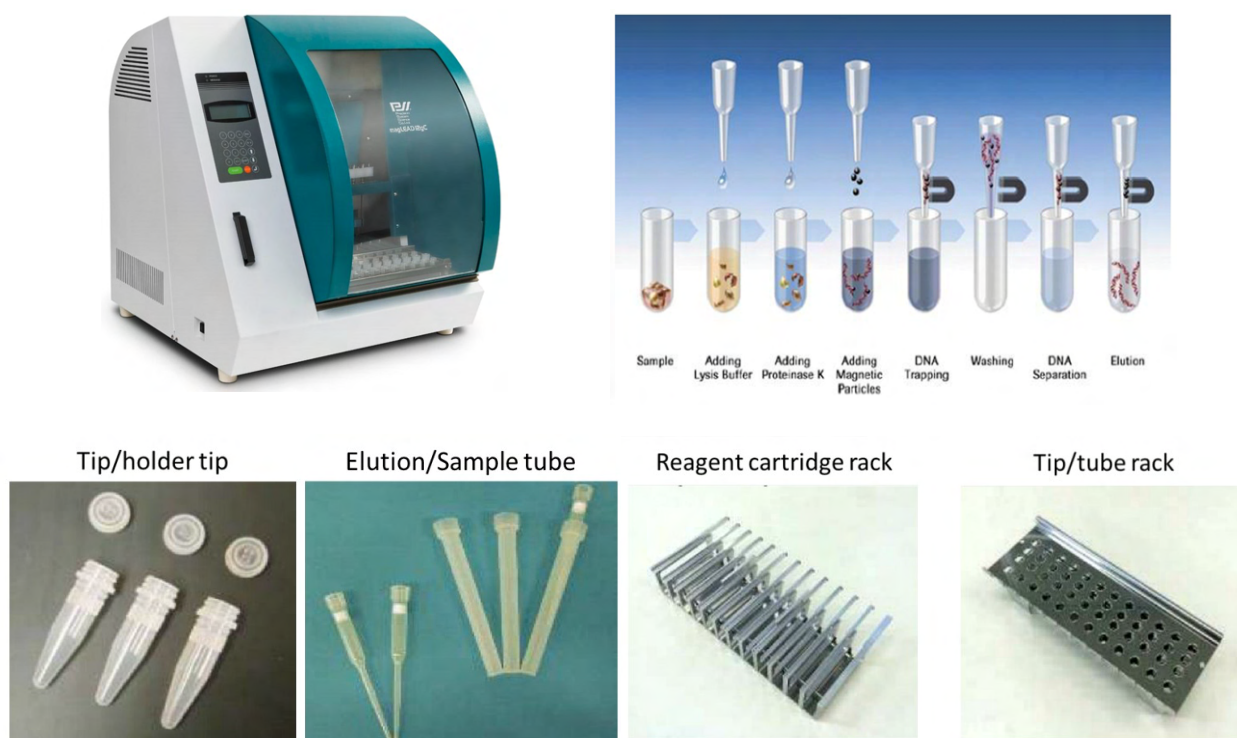
รูปที่ 18 เครื่องสกัดสารพันธุกรรมแบบอัตโนมัติ PSS รุ่น Maglead 12gC และอุปกรณ์
