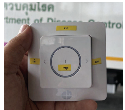
รูปที่ 9 รีโมทไร้สาย สำหรับควบคุมการทำงานของผ้าใบกันสาด
