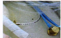
สายน้ำ-ลม ที่ทำจาก Polyurethane (PU)
