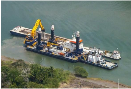
ขุดแบบเครื่องมือกล (Mechanical Dredging) หรือ รถแบบโซบนโป๊ะบรรทุก
