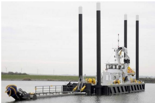
เรือขุดแบบไฮดรอลิก (Hydraulic Dredging) หรือ เรือขุดแบบ Cutter suction
