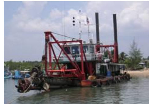
เรือขุดแบบไฮดรอลิก (Hydraulic Dredging) หรือ เรือขุดแบบ Cutter suction
