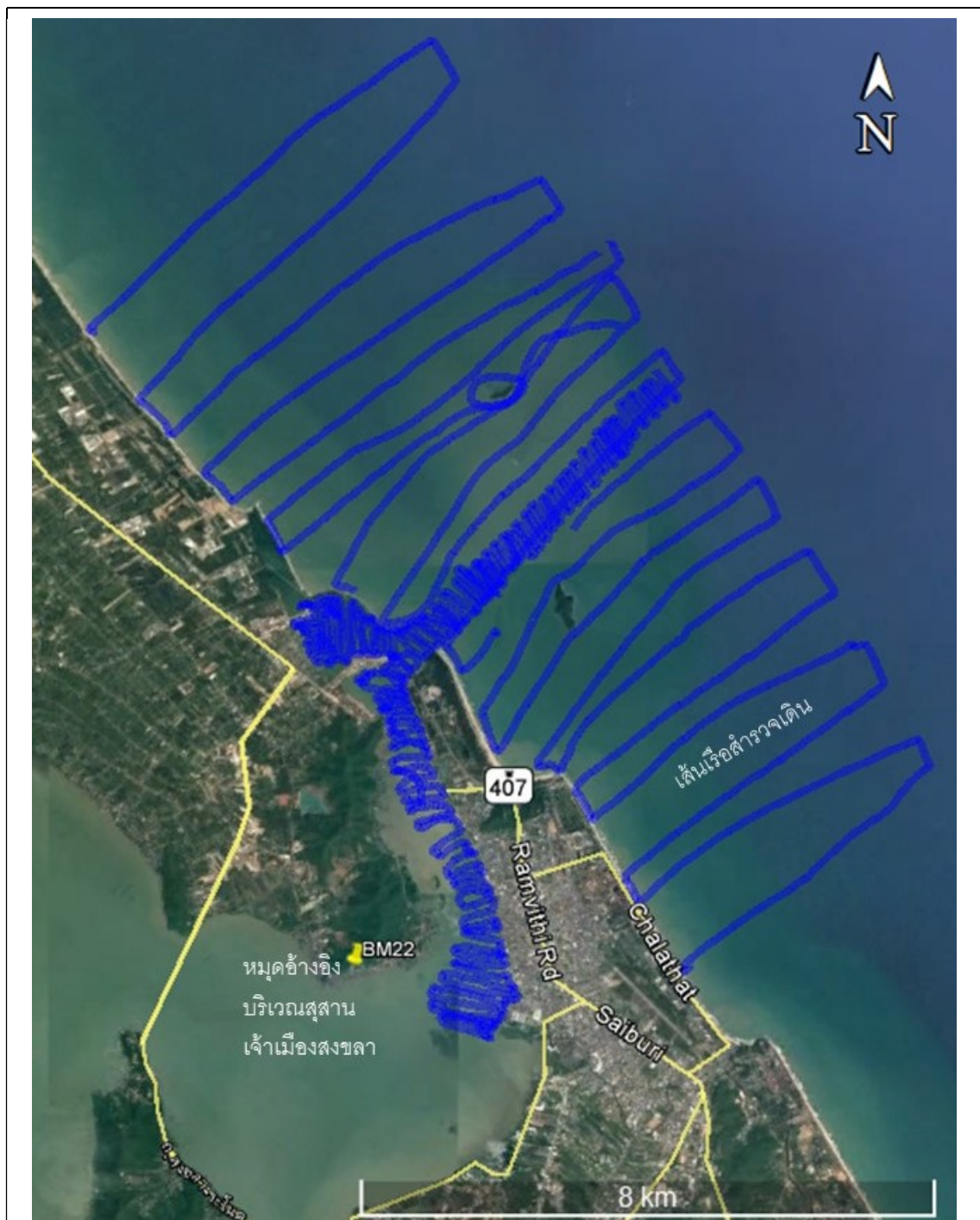
รูปที่ 8 - 5 ตำแหน่งหมุดอ้างอิงและเส้นเรือสำรวจเดิน
