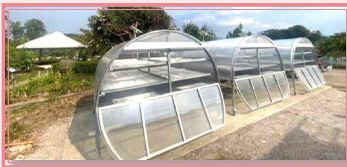
ภาพที่ ๓ ระบบอบแห้งพลังงานแสงอาทิตย์ ขนาด ๒ x ๒ เมตร ณ โรงพยาบาลค่ายสุรศักดิ์มนตรี กลุ่มงานแพทย์แผนไทย
