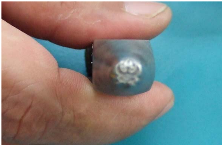
ภาพที่ 5 ภาพเครื่องหมายคำรับรอง (ตราครุฑ) ซึ่งนำไปตอกลงบนเครื่องชั่งเมื่อผ่านการตรวจรับรองแล้ว
