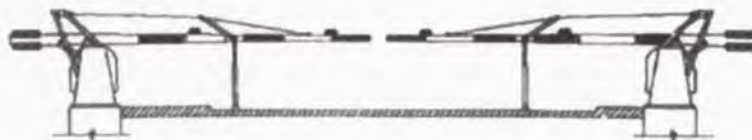
รูปที่ ๕๗ เครื่องกันถนนชนิดคานทำงานด้วยไฟฟ้า
