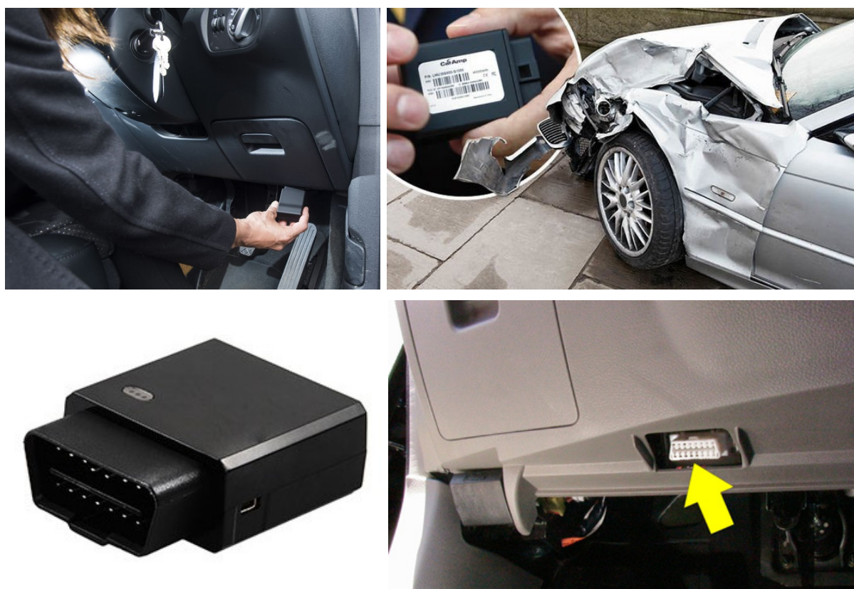
รูปที่ 2.1 ระบบ Telematics Insurance โดยการเชื่อมโยงข้อมูลจากกล่องควบคุมการทำงานของรถยนต์ (ECU) ผ่านพอร์ต OBDII
