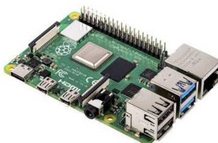
รูปที่ 5.44 อุปกรณ์ Embedded Linux Board ที่ใช้ร่วมกับการพัฒนาอุปกรณ์ระบุตัวตนผ่าน RFID
