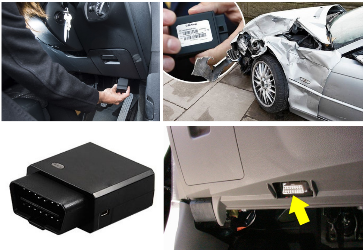
รูปที่ 4.29 ระบบ Telematics Insurance โดยการเชื่อมโยงข้อมูลจากกล่อง ECU ผ่านพอร์ท OBDII
