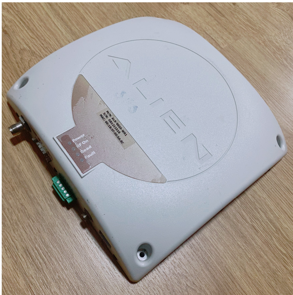
รูปที่ 5.43 Alien RFID Reader รุ่น ALR-9650
