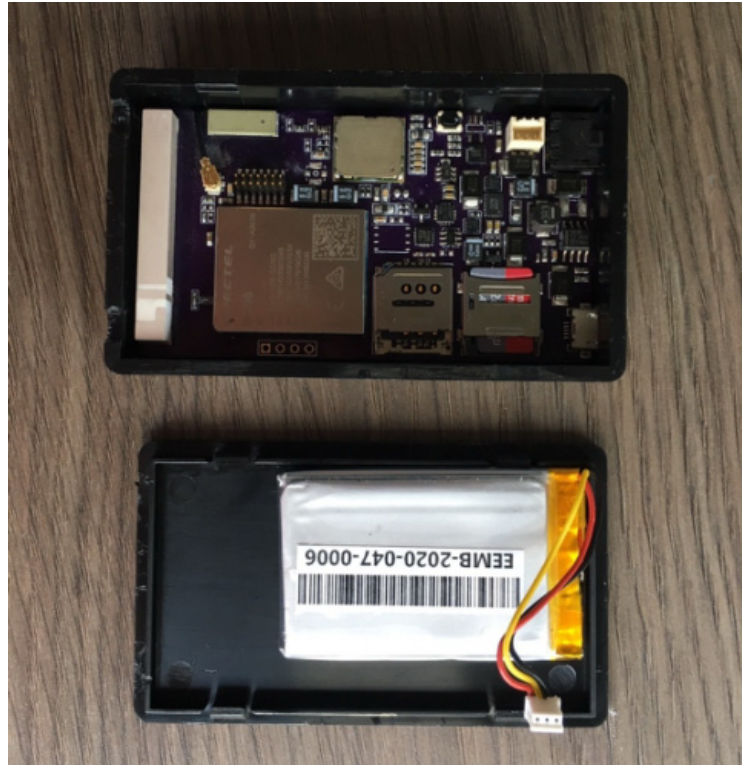
รูปที่ 5.30 ลักษณะภายในของอุปกรณ์ต้นแบบชนิด GPS ร่วมกับการสื่อสารชนิด LoRa
