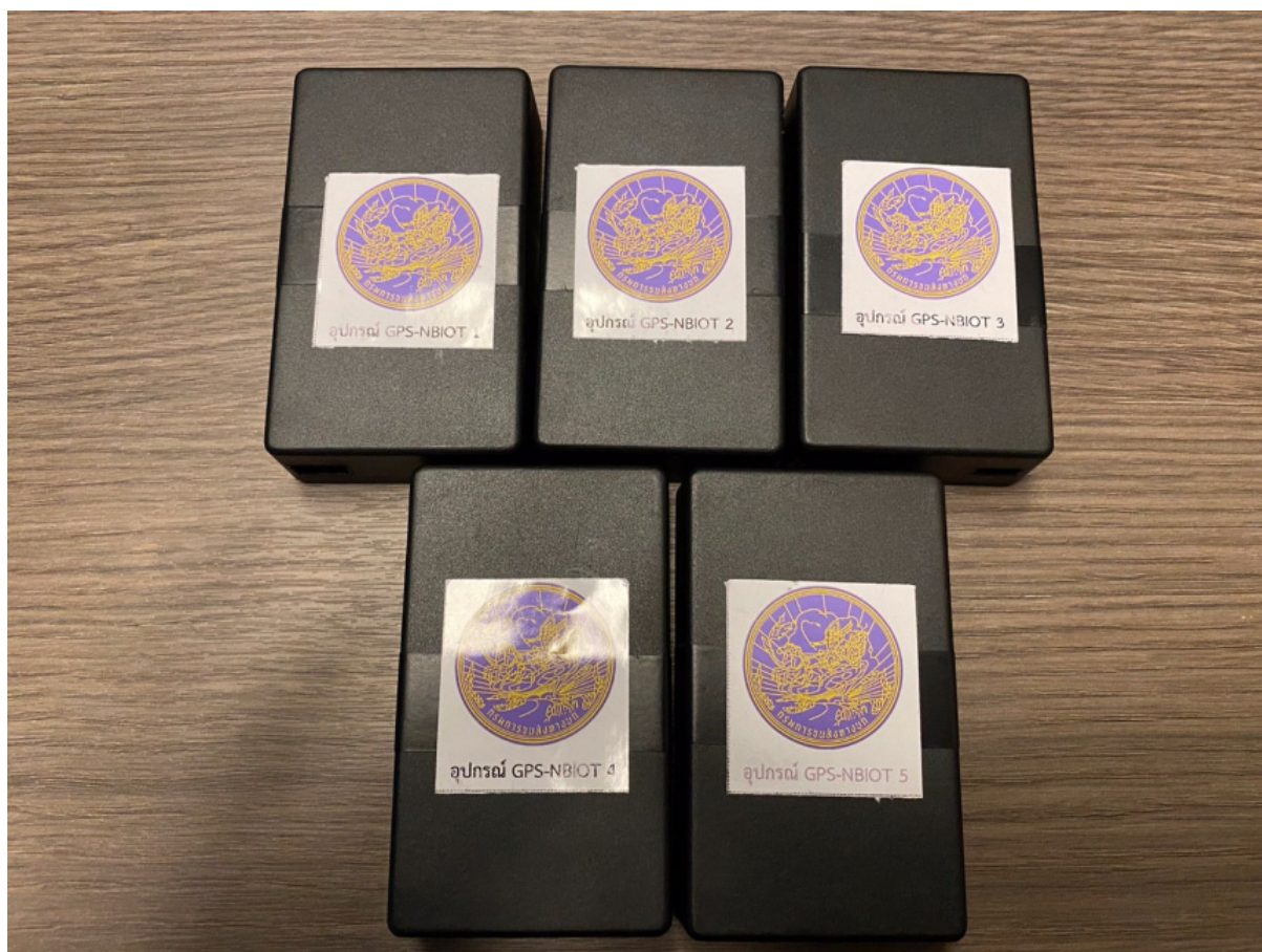
รูปที่ 5.22 รูปอุปกรณ์ต้นแบบชนิด GPS ร่วมกับการส่งข้อมูลผ่านเครือข่าย NB-IoT
