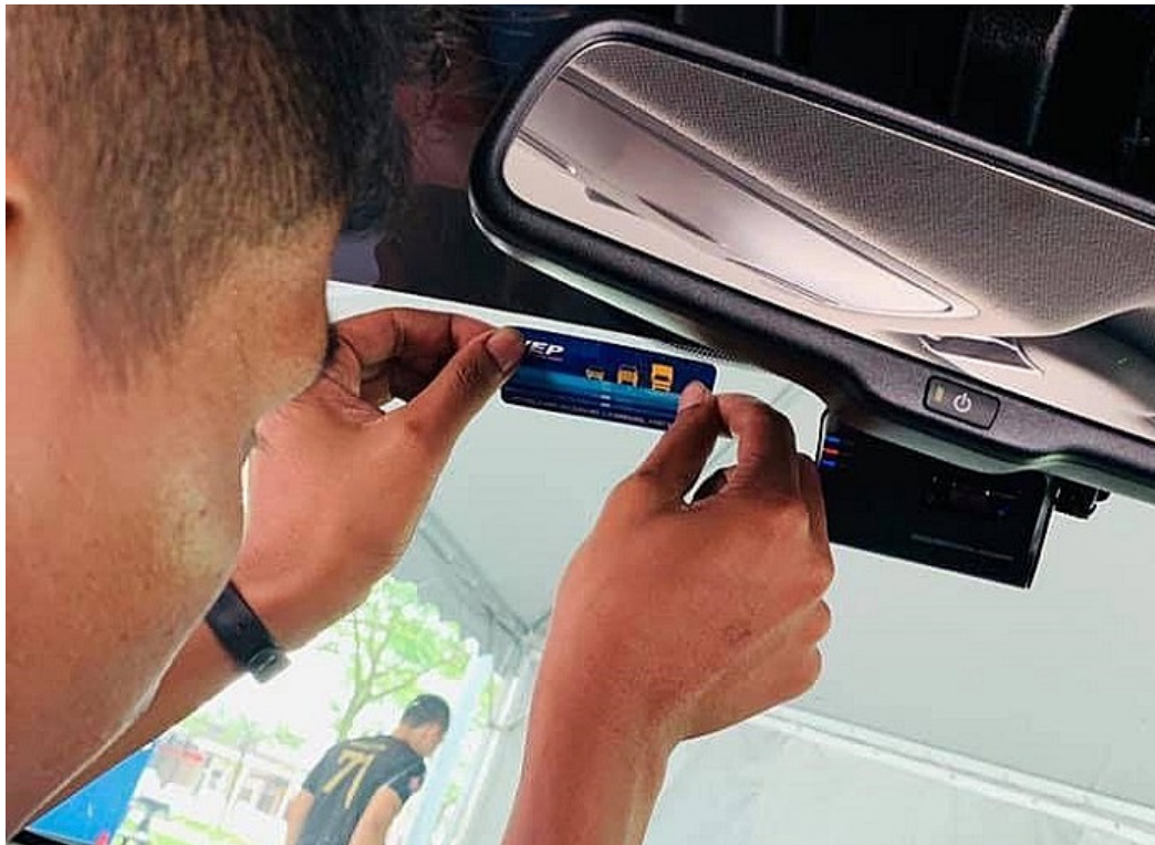
รูปที่ 4.37 การติดตั้ง RFID Tag ของประเทศมาเลเซีย บริเวณกระจกหน้าของรถยนต์
