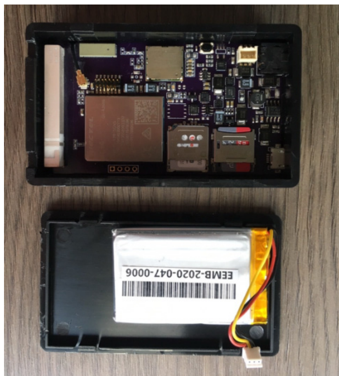
รูปที่ 5.23 ลักษณะภายในของอุปกรณ์ต้นแบบชนิด GPS ร่วมกับการส่งข้อมูลผ่านเครือข่าย NB-IoT
