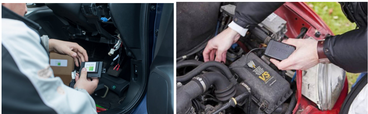
รูปที่ 4.30 ระบบ Telematics Insurance แบบ GPS Black Box
