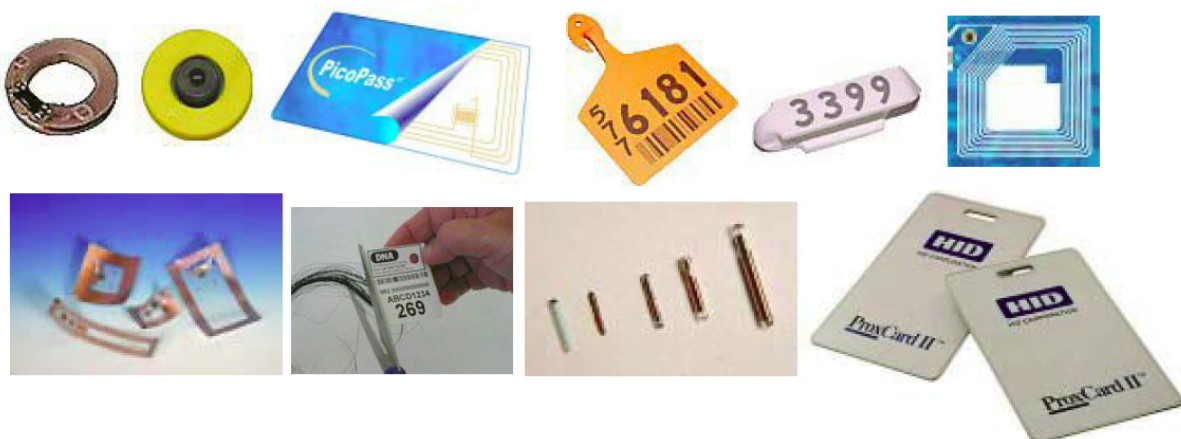
รูปที่ 4.22 RFID แท็กในรูปแบบต่างๆ
