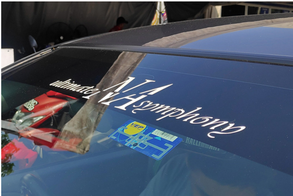
รูปที่ 4.38 การติดตั้ง RFID Tag บริเวณกระจกหน้าของรถยนต์เมื่อมองจากด้านนอก
