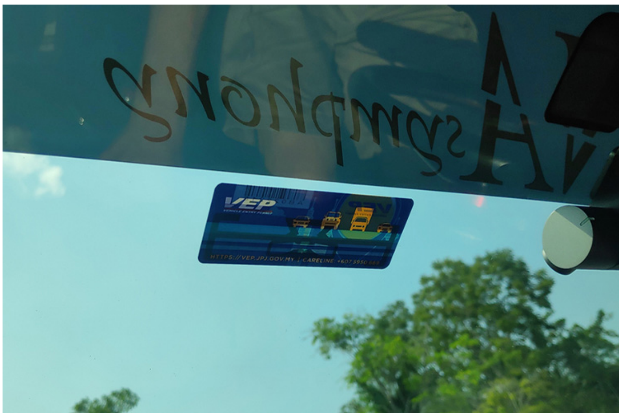
รูปที่ 4.39 การติดตั้ง RFID Tag ของประเทศมาเลเซีย เมื่อมองจากด้านในรถ
