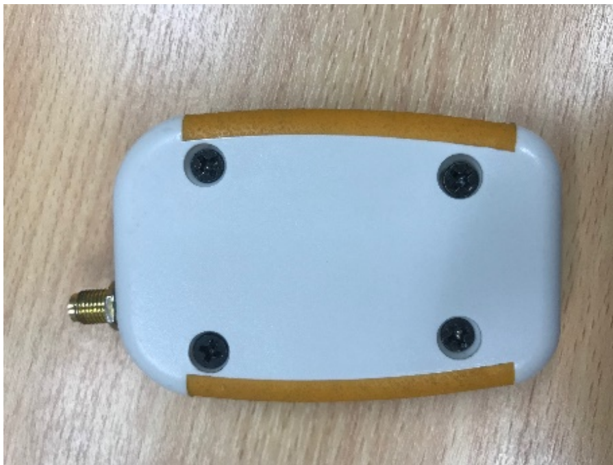
รูปที่ 4.4 อุปกรณ์ตรวจวัดพิกัดจากดาวเทียมที่มีเซ็นเซอร์ตรวจจับการถอดอุปกรณ์
