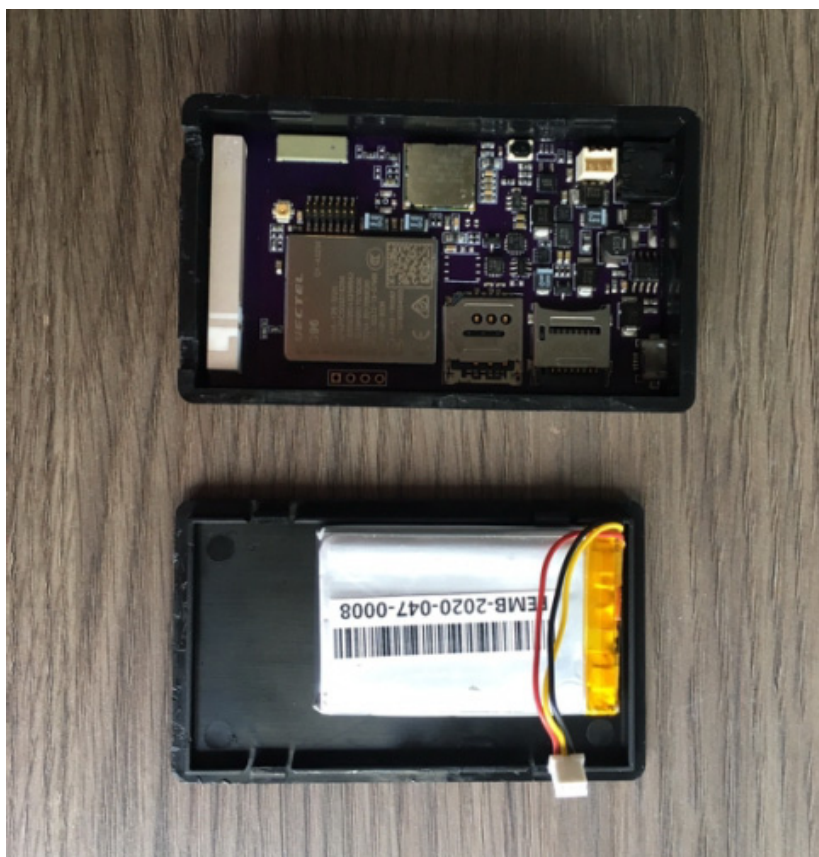
รูปที่ 5.36 ลักษณะภายในของอุปกรณ์ต้นแบบชนิด Lora
