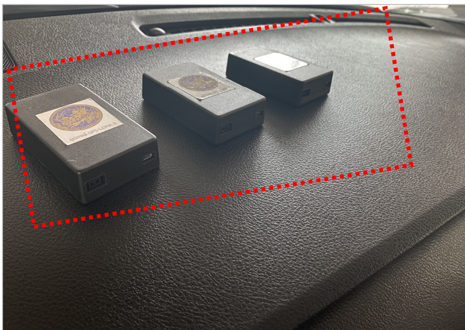
รูปที่ 5.55 การติดตั้งอุปกรณ์กับรถกระบะที่ใช้ในการทดสอบ
