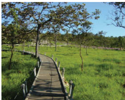
▲ สะพานทางเดินพื้นไฟเบอร์กลาสเสาปูน ราวสลิงเสาเหล็ก อุทยานแห่งชาติปาหนิงงาม จังหวัดชัยภูมิ
