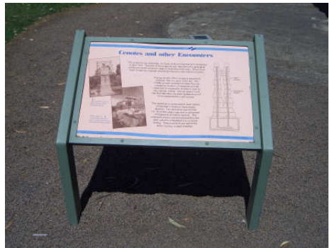
▲ ป้ายสื่อความหมาย เป็นวัสดุเหล็กและอะลูมิเนียม แบบสองขา
