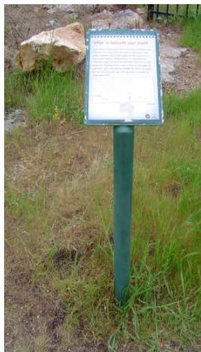
◀ ป้ายสื่อความหมาย เสาเหล็ก ตัวป้ายเป็นกระดาษเคลือบ Wax ติดบนเหล็ก ▲
