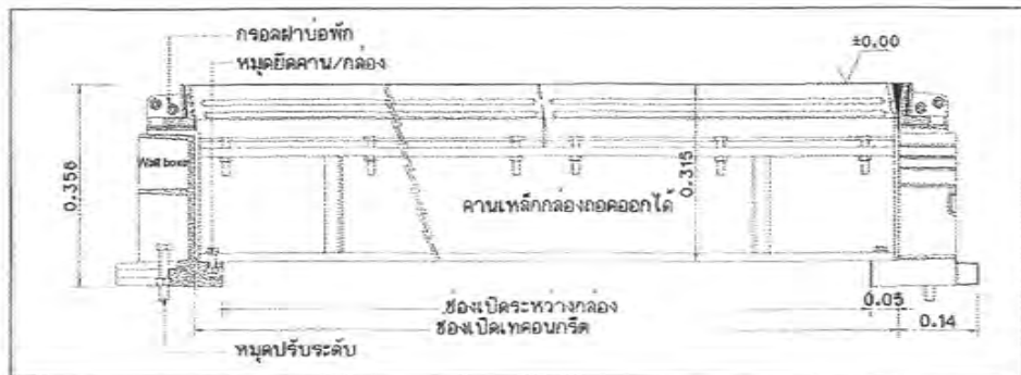
แบบแสดงรูปตัดคาน และกล่องตามยาว
