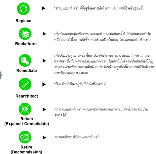
รูปที่ 14-8 ตัวอย่างโครงสร้างและหลักการ 6R สำหรับ Application Transformation
