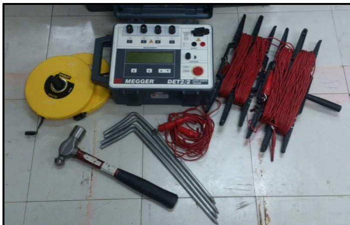
รูปที่ 1 ตัวอย่างเครื่องมือและอุปกรณ์ที่ต้องใช้ในการวัดค่าความต้านทานดิน
