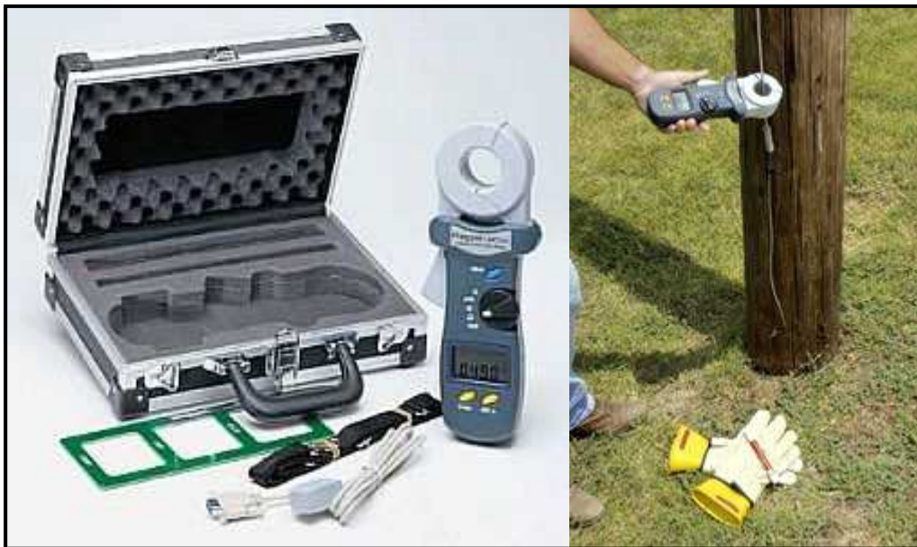
รูปที่ 5 เครื่องมือวัดค่าความต้านทานหลักดินแบบ Clamp-on (แบบคล้อง)
