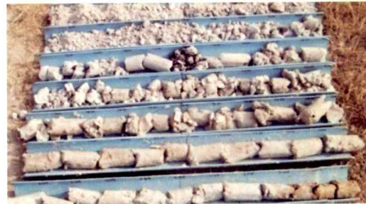
ลักษณะของตัวอย่างทรายแก้ว (สีขาว) ที่ได้จากการเจาะด้วยวิธีใช้มือหมุน (hand auger)
