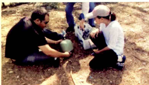
การติดตั้งเครื่องมือในการสำรวจไมโครโทรเมอร์
