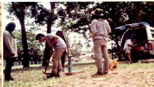
การสำรวจธรณีฟิสิกส์โดยการวัดความเร็วของคลื่นเฉือนของชั้นดิน ในหลุมเจาะ Downhole test
