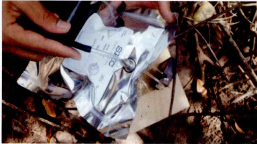
เก็บตัวอย่างก๊าซมีเทนโดยใช้กล่องเก็บตัวอย่าง
