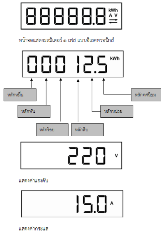
รูปที่ ๓.๔ ตัวอย่างภาพแสดงการอ่านหน่วยมิเตอร์ ๑ เฟส แบบอิเล็กทรอนิกส์
