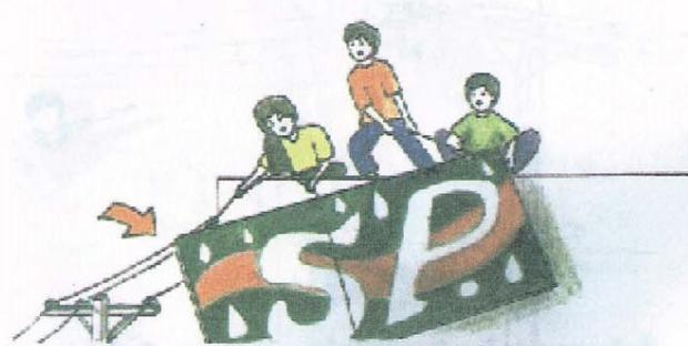
๘. การติดตั้งป้ายโฆษณาหรือสิ่งอื่นๆ ที่อยู่ใกล้สายไฟฟ้าแรงสูงต้อง ระวังอย่าให้วัสดุต่างๆ ไป接触สายไฟฟ้าแรงสูง ควรบริการข้อความนี้การไฟฟ้าส่วนภูมิภาคในท้องถิ่น เพื่อดำเนินการครอบฉนวนป้องกันมิให้เกิดอันตรายได้
