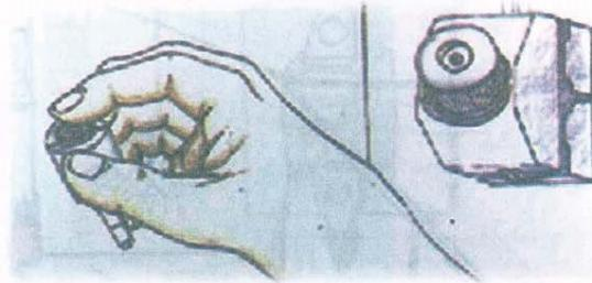
๑๑. ฟิวส์ที่ใช้ตามแรงสวิตช์ต่างๆ ต้องติดตั้งขนาดให้ถูกต้องและ เหมาะสม เมื่อฟิวส์ขาดควรทำการตรวจหาสาเหตุโดยเบื้องต้นด้วยก่อน ที่จะเปลี่ยนฟิวส์ใหม่และต้องใส่ฟิวส์ขนาดเดิม ห้ามใช้สายไฟหรือลวดใดแทนฟิวส์ เพราะเมื่อเกิดกระแสไฟฟ้าลัดวงจรสายไฟหรือลวดจะไม่ขาด อาจเกิดอัคคีภัยได้
