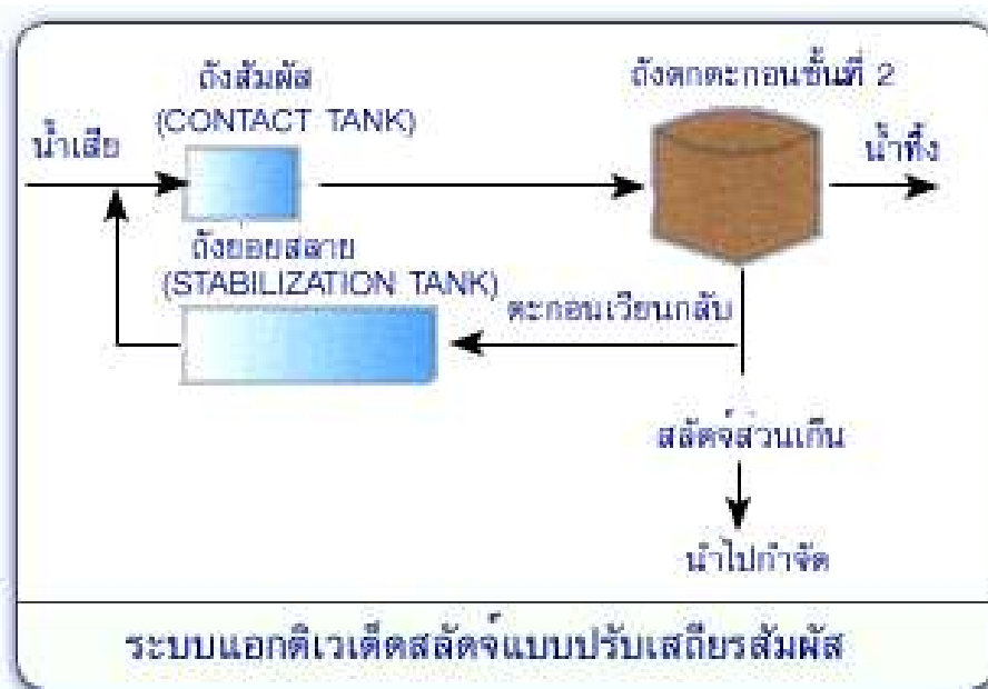
รูปที่ 5 - 5 ผังกระบวนการบำบัดน้ำเสียแบบแอกทิเวเต็ดสลัดจ์แบบปรับเสถียรสัมพันธ์
