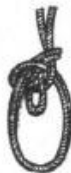
บ่วงตาช้อนสองรอบ DOUBLE BOWLINE
