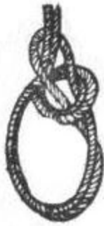
บ่วงสายธนูสองชั้น BOWLINE ON A BIGHT
