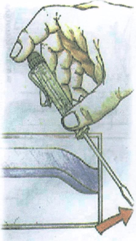
๖. เครื่องอิเล็กทริกภายในบ้านที่ผิดนอกเป็นโนล๊อค เช่น ตู้เย็น พัดลม เครื่องซูบัน อาจมีกระแสไฟฟ้ารั่วไปที่ผิดภายนอกดังกล่าวได้ ท่านควรหมั่นตรวจสอบโดยใช้ไขควงเข็มไฟตรวจสอบ หากพบว่ามีกระแสไฟฟ้ารั่วควรใช้หางซุ่มและแมกนีตอุปโภค
