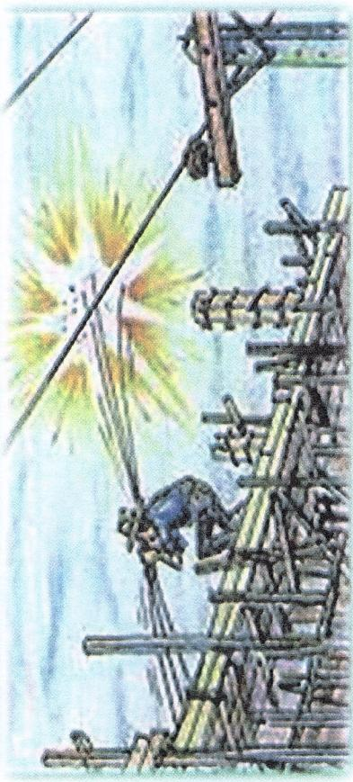
๕. ไม่ออก去做任何工程的施工，或者靠近電線杆子，以免受到電擊傷害。
