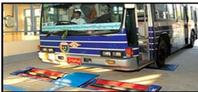
การทดสอบความเที่ยงตรงของเกจวัดความเร็ว
